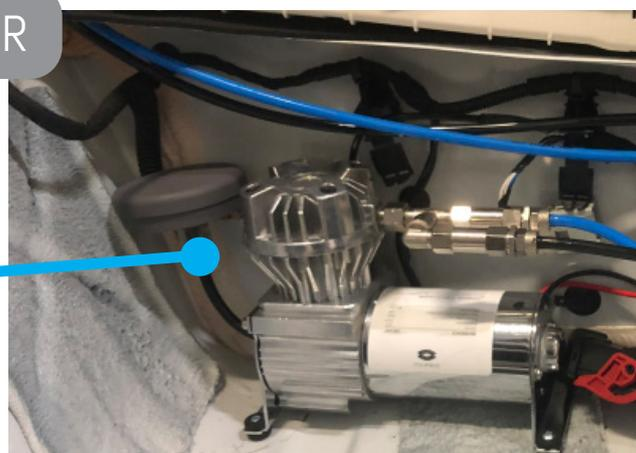
6.5 - **Caler** le compresseur au fond du logement, sous le marchepied et **s'assurer qu'il ne gênera pas** lors de la remise en place du cache plastique. **Procéder aux raccords** : pneumatiques, électriques et filtre.
