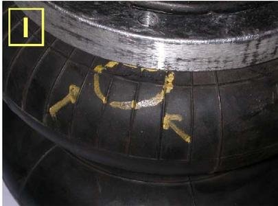
Coussin endommagé à cause d'un frottement contre le flanc caoutchouc. Ce dommage peut se produire si on utilise continuellement trop peu de pression dans les coussins, ce qui provoque un frottement entre la collette résine (ou aluminium) et le caoutchouc.
