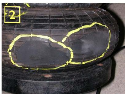
Abrasion due au frottement. Si, pendant le montage les distances minimum de dégagement autour du coussin ne sont pas respectées, certaines parties peuvent frotter contre les coussins et provoquer une usure du caoutchouc.
