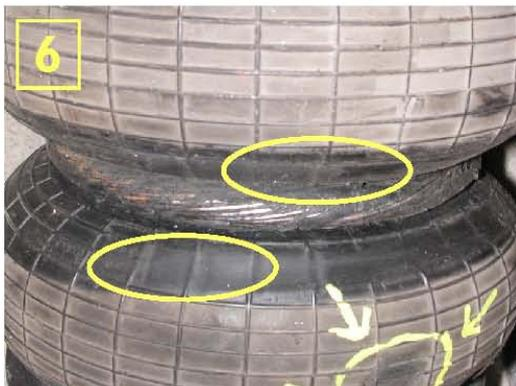
Déformation : Trop peu de pression et/ ou un véhicule en surcharge peuvent provoquer une déformation à l'extérieur de la coquille caoutchouc à cause du contact avec la tresse métallique centrale de maintien.
