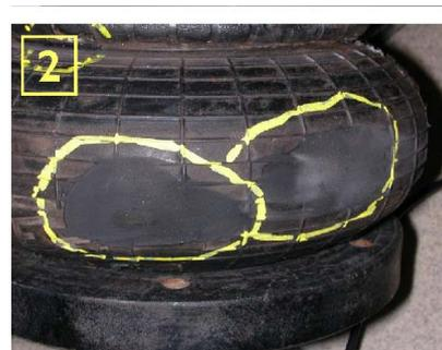
Abrasion due au frottement. Si, pendant le montage les distances minimum de dégagement autour du coussin ne sont pas respectées, certaines parties peuvent frotter contre les coussins et provoquer une usure du caoutchouc.
