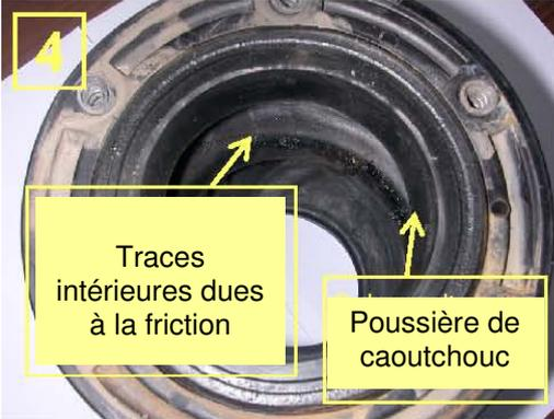
Traces d'écrasement trop important. L'intérieur de la coquille caoutchouc présente des traces à cause d'un contact prolongé du coussin avec le support supérieur. Ce contact provoque une friction entre les surfaces caoutchouc et crée également de la poussière de caoutchouc.
