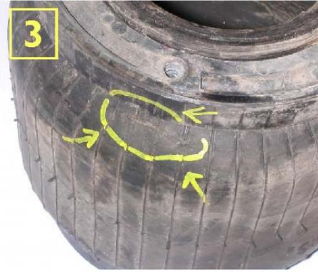
Déchirure : Dans le cas d'un véhicule chargé, le fait d'avoir trop peu de pression dans les coussins durant une longue période provoque un contact entre la collerette et le coussin. Une déchirure se produit dans la coquille caoutchouc et une fuite d'air apparaît.
