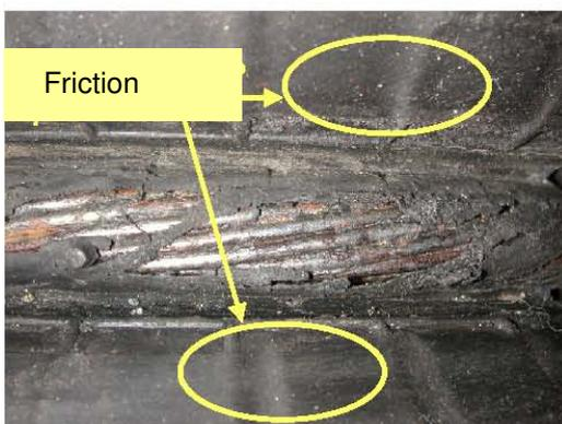
Endommagements du coussin à cause de frottements entre les parties arrondies supérieure et inférieure. Une usure du caoutchouc se produit à cause d'un manque de pression d'air ou une surcharge du véhicule.
