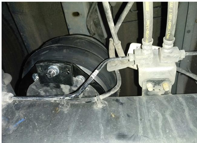
Plier le support de câble de frein vers la suspension d'un angle de 45° environ afin de l'éloigner du coussin d'air.
