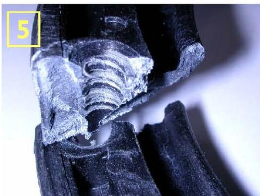
Flanc craquelé à cause d'une pression trop importante (si elle est 10 fois supérieure à la pression normale). Ceci est provoqué par une pression excessive de gonflage des coussins et / ou par une surcharge du véhicule au-delà de la limite autorisée par le constructeur du véhicule.
