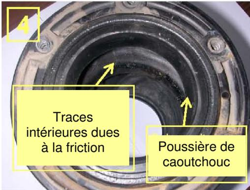
Traces d'écrasement trop important. L'intérieur de la coquille caoutchouc présente des traces à cause d'un contact prolongé du coussin avec le support supérieur. Ce contact provoque une friction entre les surfaces caoutchouc et crée également de la poussière de caoutchouc.
