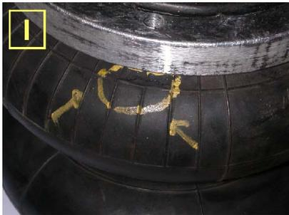
Coussin endommagé à cause d'un frottement contre le flanc caoutchouc. Ce dommage peut se produire si on utilise continuellement trop peu de pression dans les coussins, ce qui provoque un frottement entre la collerette résine (ou aluminium) et le caoutchouc.
