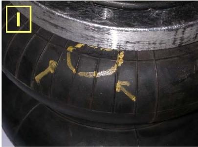
Coussin endommagé à cause d'un frottement contre le flanc caoutchouc. Ce dommage peut se produire si on utilise continuellement trop peu de pression dans les coussins, ce qui provoque un frottement entre la colerette résine (ou aluminium) et le caoutchouc.
